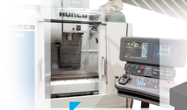
CENTRE D'USINAGE HURCO VM1 et VM10 7,5 KW courses X660 Y335 Z457
