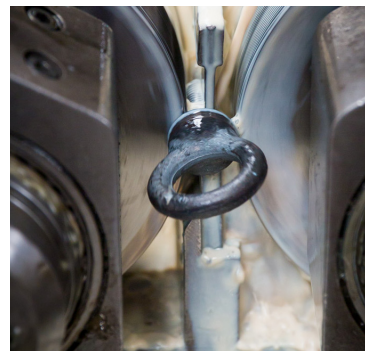
MACHINE À ROULER ESCOFFIER Ø12 pas trap de 3 à Ø40 pas trap de 7
