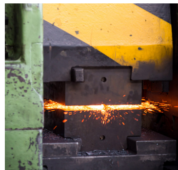
LIGNE DE FORGE Marteau pilon MONTBARD LG750 1700 Kg/m - pièces de 40 à 2200 g
